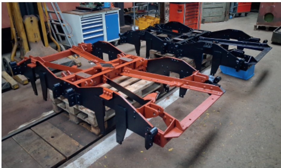
▲ Die Drehgestellrahmen werden gestrichen. Bild: Dirk Dederer
