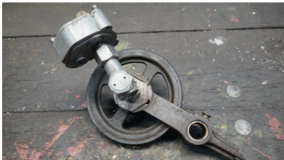
▲ Der Tachogeber von Lok 22-03 ist aufgearbeitet. Bild: Stefan Haag
