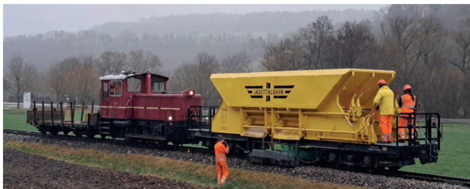
▲ Auf der Bühne werden die Schotterklappen bedient. Der Helfer unten gibt an, wie viel Schotter gebraucht wird. Bild: Andreas Hümmlchen
