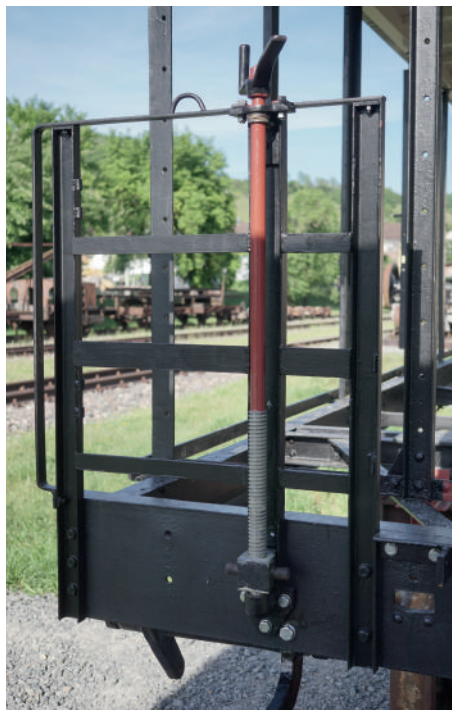
▲ Die neue Handbremskurbel, ein Teil des Gestänges und Bühnengeländer sind montiert. Bild: Stefan Haag
