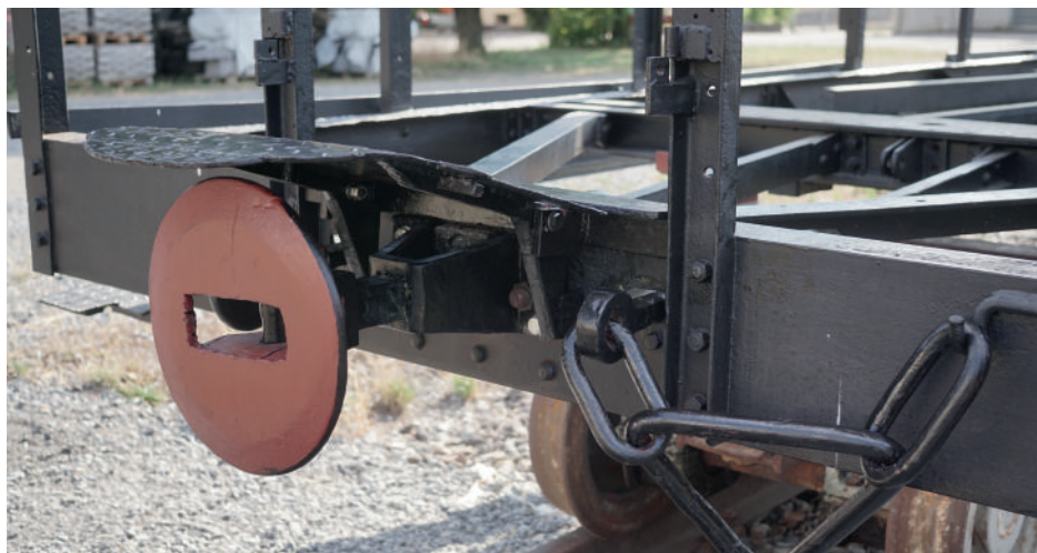
▲ Eine Zug- und Stoßeinrichtung ist wieder montiert. Bild: Stefan Haag
