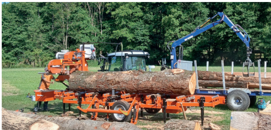
▲ Ein Eichenstamm wird auf dem mobilen Sägewerk zu Brettern für Wagenböden gesägt. Bild: Ron Scherhauser
